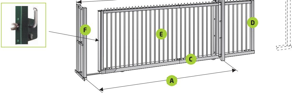
A - Ouverture   B - Dimension total   C - Profil   D - Profil   E - Tubes verticaux   F - Tour
